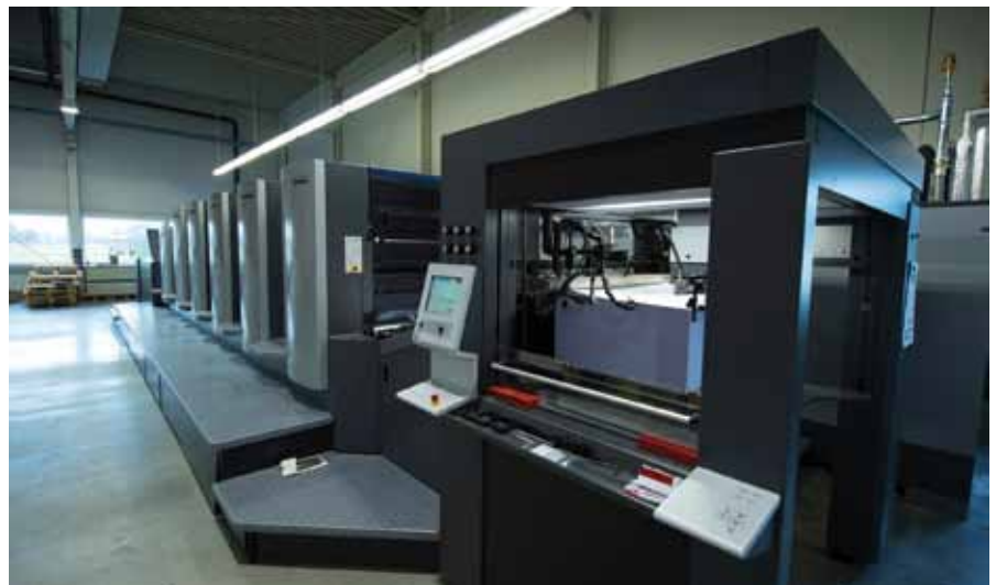
Ein kompletter Plattenwechsel inklusive des Waschens der Gummitücher dauert gerade einmal etwas mehr als zwei Minuten.
